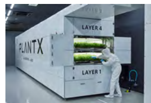
密閉型構造の植物工場
